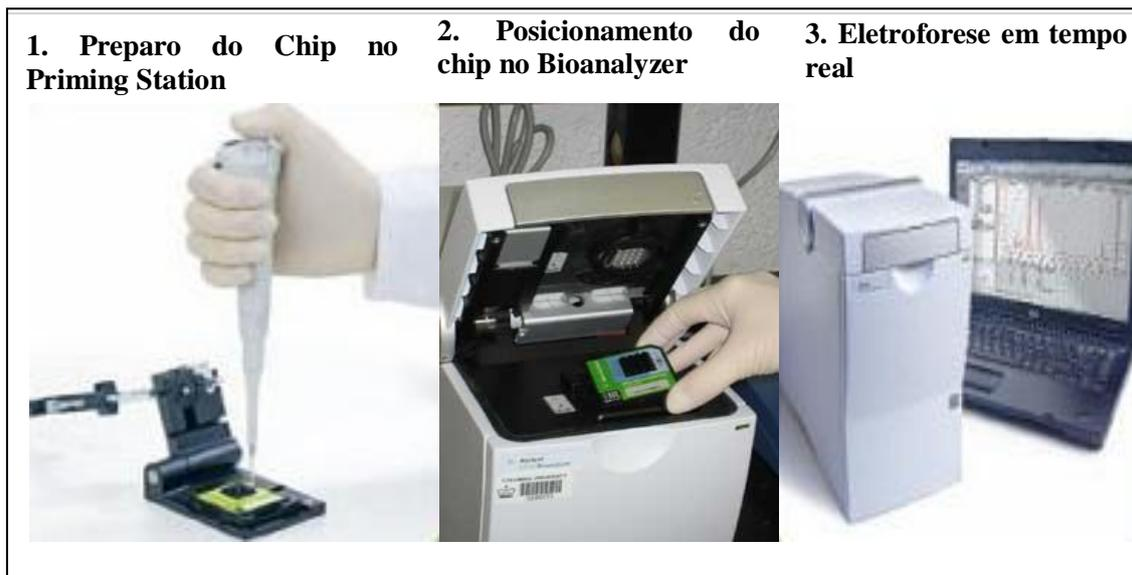
Figura 6 – Fluxograma para preparação dos RNA *Nano Chip*. Utilização do equipamento *Bioanalyzer* 2100 Agilent, para avaliação da qualidade das amostras de RNA total.
