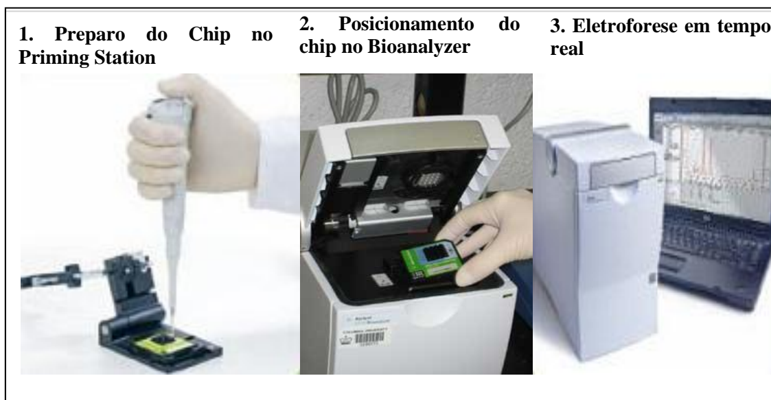
Figura 5 – Fluxograma para preparação dos RNA Small Chip utilizando o equipamento Bioanalyzer 2100 Agilent, para avaliação das amostras de RNA total.
