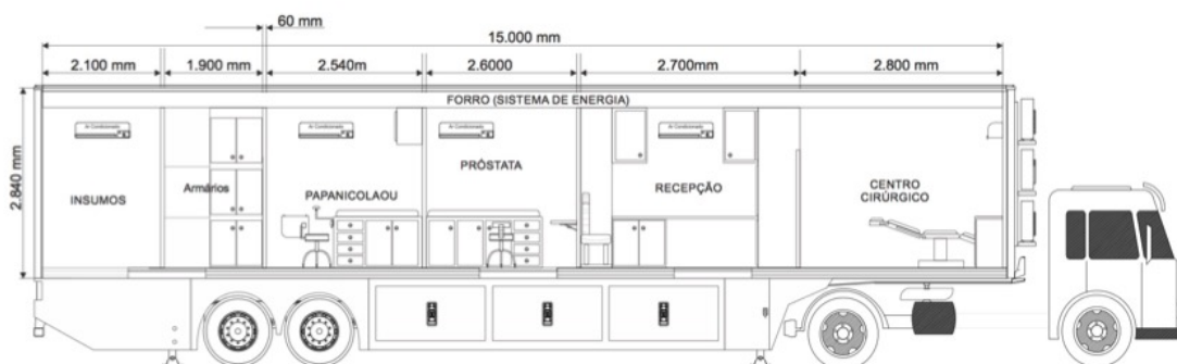
Figura 7 – Modelo de unidade móvel utilizada pelo Hospital de Câncer de Barretos. (Fonte: Departamento de Engenharia do Hospital de Câncer de Barretos).
