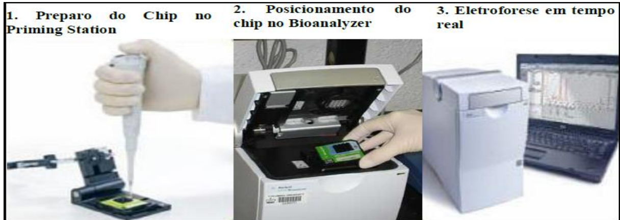
Figura 2- Fluxograma para preparação do RNA Nano Chip . Utilização do equipamento Bioanalyzer 2100 Agilent , para avaliação das amostras de RNA total.
