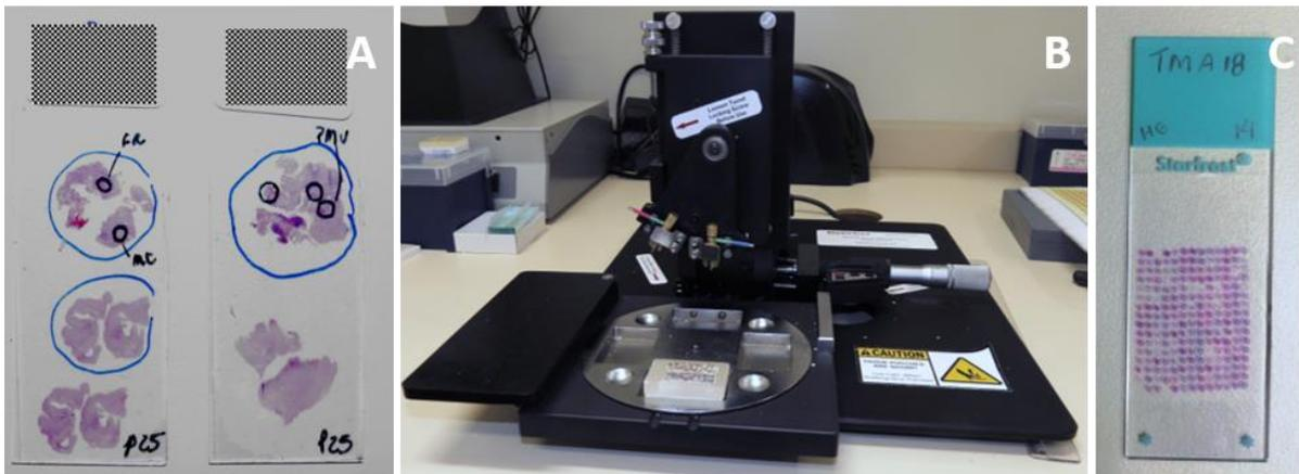
Figura 5 – Método de preparação dos TMAs. A) Plataforma de TMA. B) Marcação das áreas de diferentes padrões histopatológicos. C) Lâmina de um dos TMAs corada por HE.
