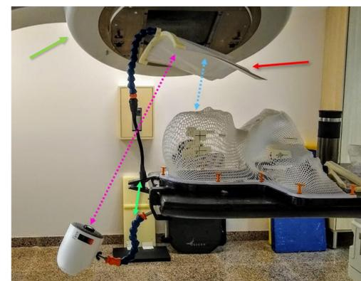
Imagem 4 – Exemplo do protótipo montado e medições realizadas. Em azul a distância mínima confortável. Em vermelho a tela. Em rosa a distância focal mínima. Em verde está indicado o *gantry* do equipamento e é evidente a proximidade deste com o dispositivo, gerando riscos de colisão.
