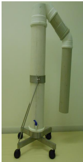
Figura 3- Volumômetro confeccionado e utilizado no estudo para avaliação do volume do membro superior.
